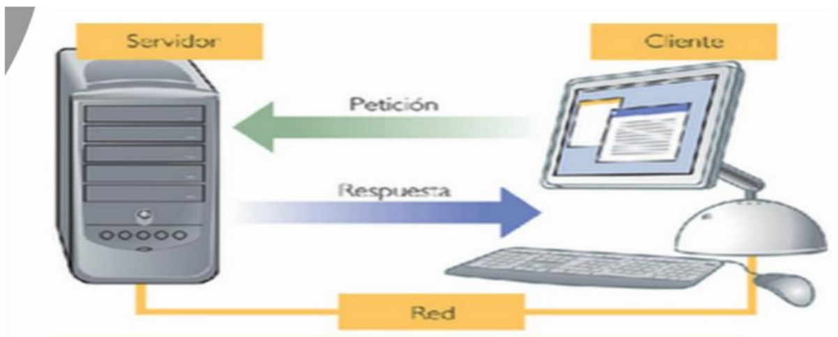
Figura 4. Arquitectura de una aplicación web (Meza Tovar. 2014)
