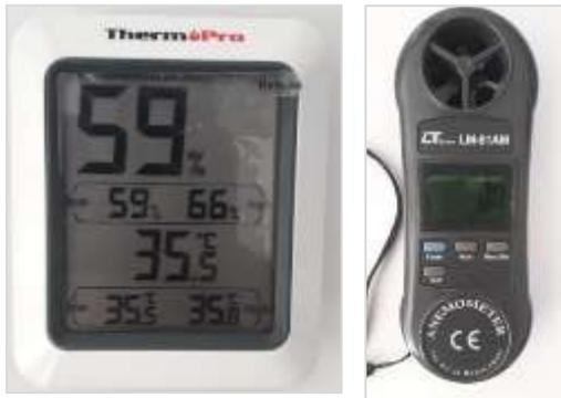
El termohigrómetro es un instrumento electrónico que en su versión más básica; mide y muestra la temperatura (T) y humedad relativa (HR) del medio, muy sencillos de interpretar. El anemómetro es un instrumento para medir la velocidad de circulación de un fluido gaseoso, en especial del viento.
