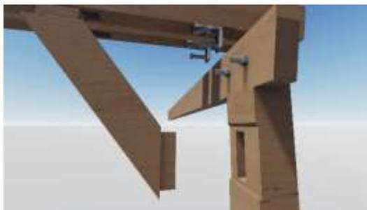
En primera instancia se cuenta con una columna, con una muesca en la parte superior de la misma y dos orificios para fijar con pernos de metal de 4 pulgadas a la estructura superior en madera (viga).
