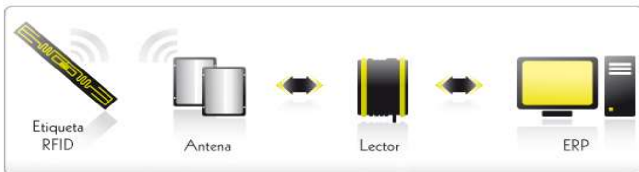
Figura 1 Elementos del sistema RFID
