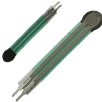
*Figura 3. Sensor FSR 400*
