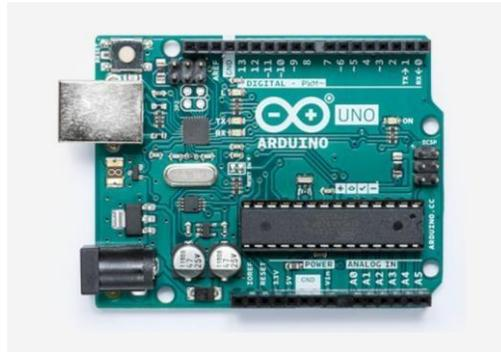
*Figura 4.* Placa arduino UNO
