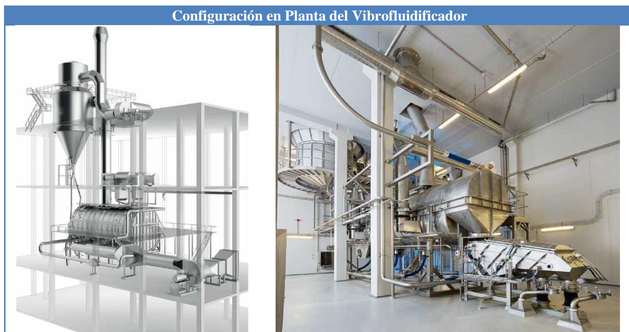
Figura 25 Disposición Característica del Lecho de Fluido Externo
