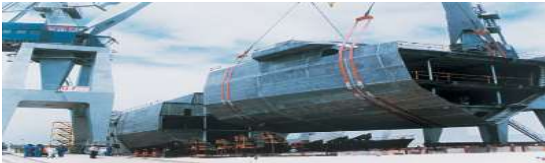
Figura 6. Distribución por posición fija, montaje de un bucle, imagen extraída de (Larez, 2016, pp. 1)
