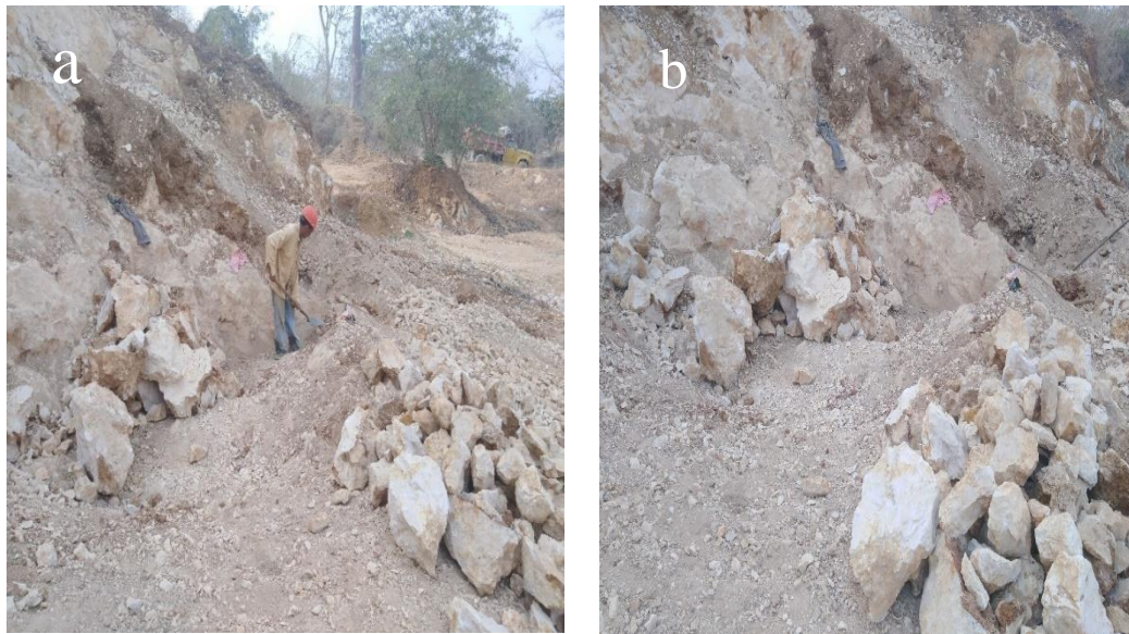
Figura 17: Extracción el material mediante métodos artesanales.
