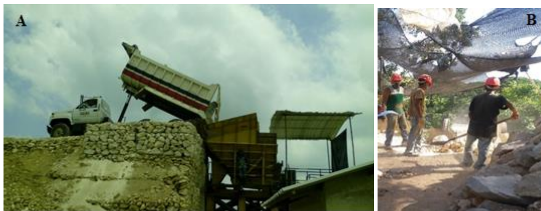
Figura 13. Descarga y alimentador de planta de trituración. Municipio de Toluviejo - Sucre. Fuente: Elaboración propia 2017.
