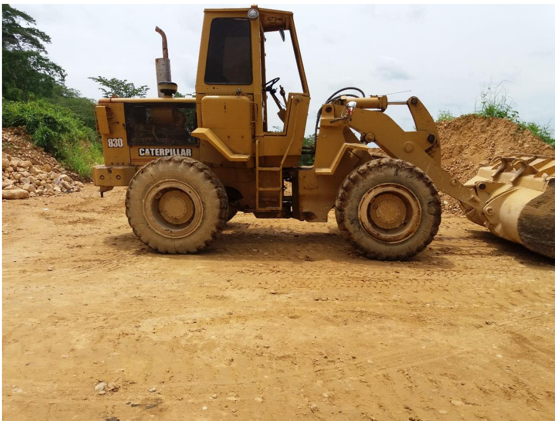
Figura 7. Máquina para la eliminación del material estéril. Municipio de Toluviejo - Sucre. Fuente: Elaboración propia 2017
