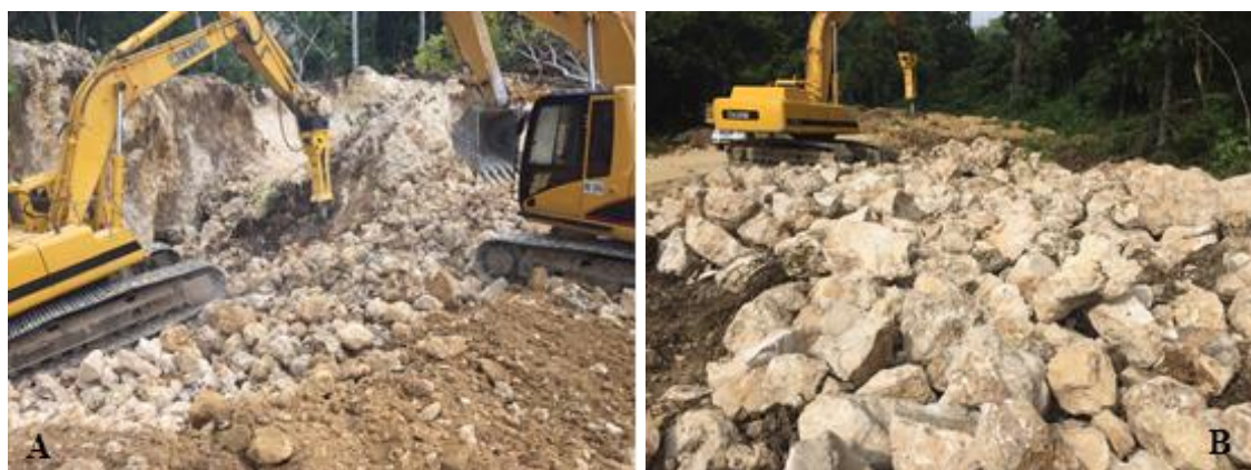
Figura 9. Extracción de materia prima de forma mecanizada. Municipio de Toluviejo - Sucre. Fuente: Elaboración propia 2017.
