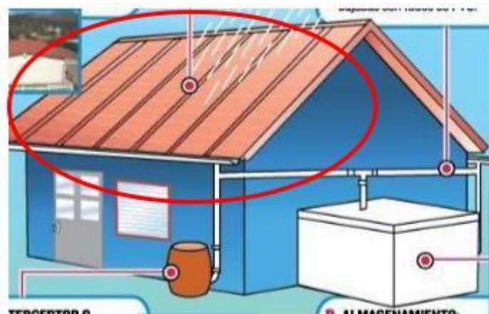
Techo en lámina galvanizada acanalada
