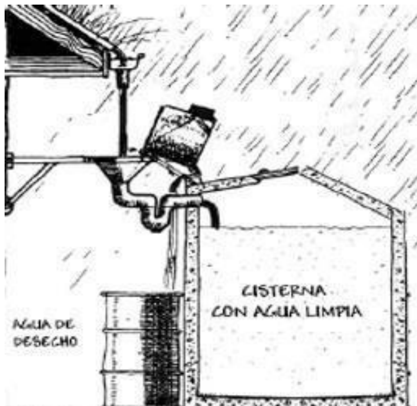
Imagen 17: Corte detallado del SCAPT Tomado de: UNATSABAR
