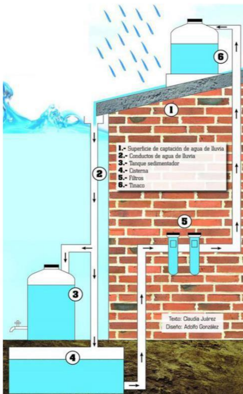
Imagen 24: Sistema de almacenamiento de agua lluvia
