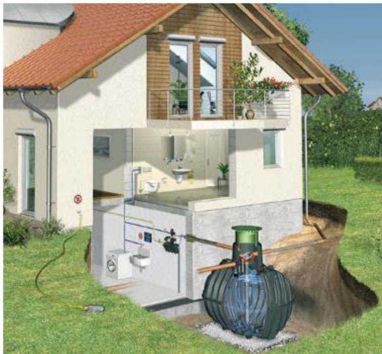
Imagen 13: Instalación de Agua Lluvias Tomado de: Casas Geo Jalisco
