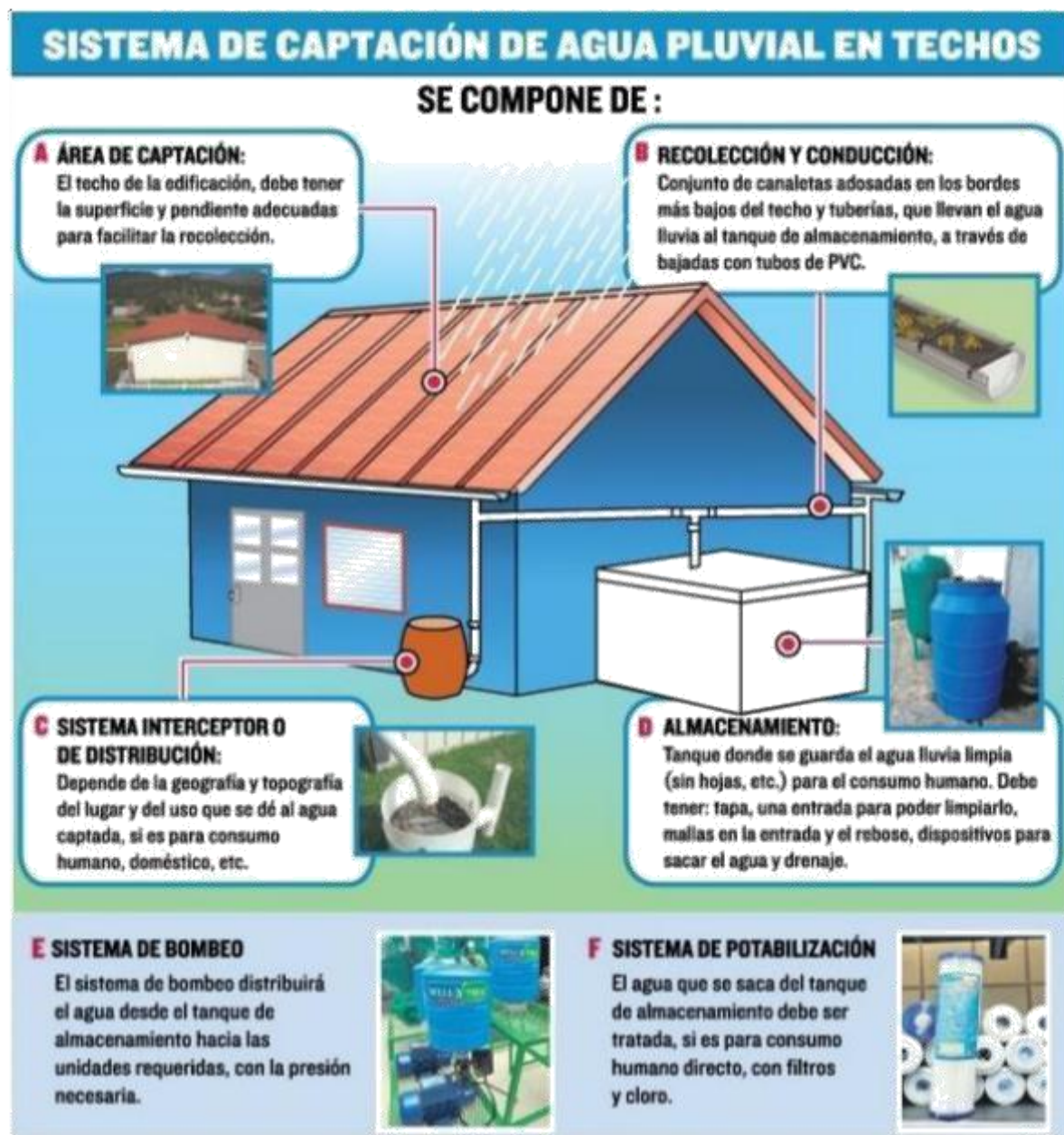
Imagen 20: Sistema de Captación de Agua Pluviales en Techos Tomado de: Revista ¿CómoVes? - UNAM
