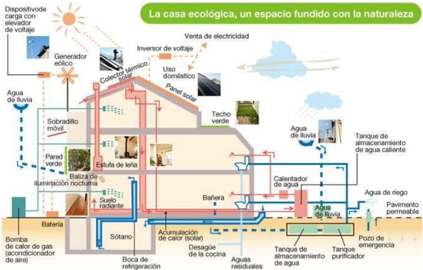
Imagen 21: Diagrama de elementos que componen una casa ecológica. Tomado de: Arq. Alexander Araque
