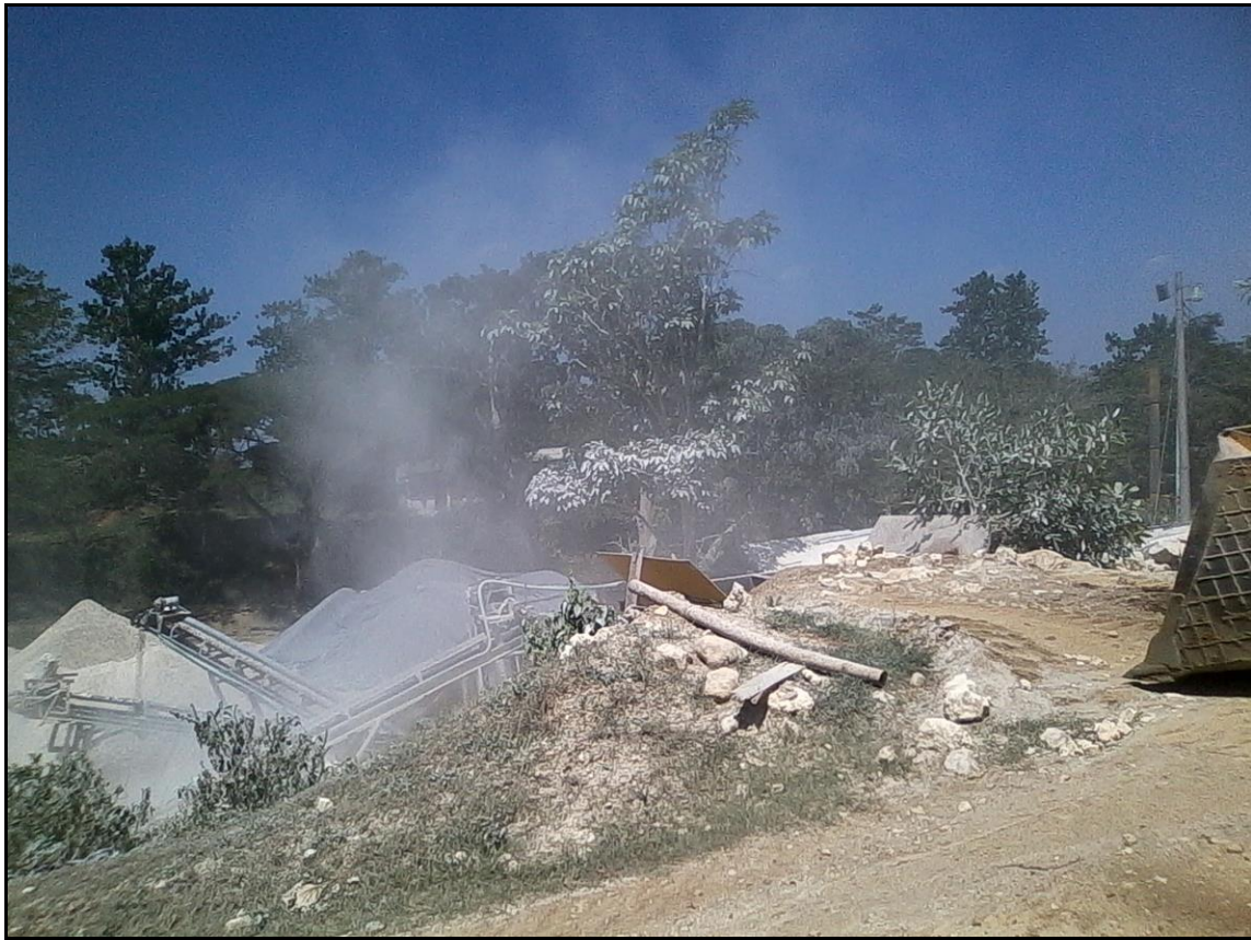
Figura 20. Material particulado liberado al aire.
