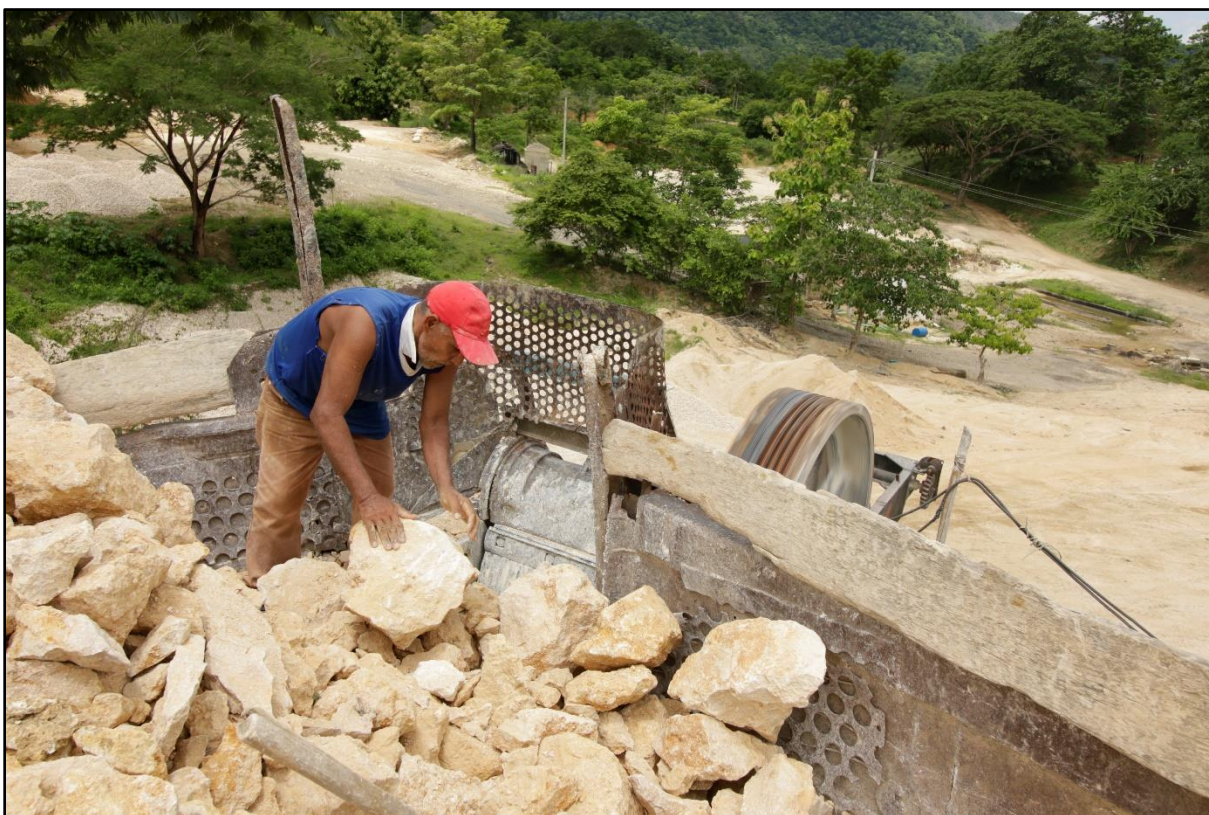
Figura 24. Trabajo en molino de mandíbula sin protección de seguridad alguna.
