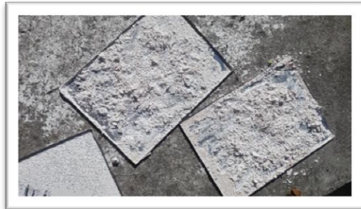
Figura 19. Secado del almidón. Fuente: autores.
