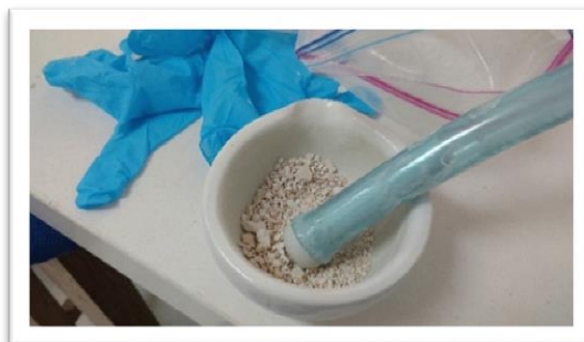
Figura 21. Triturado del almidón. Fuente: Autores.
