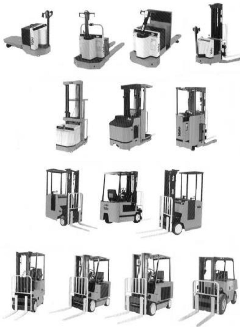
Figura 4. Montacargas industriales. Fuente: Meyers & Stephens, 2006.
