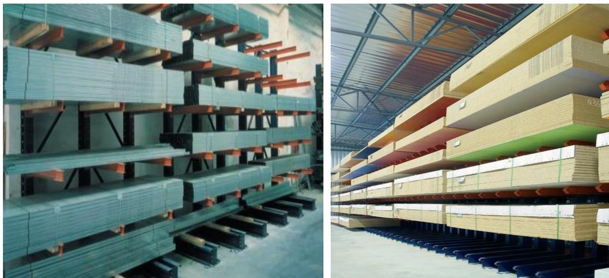
*Figura 2.* Almacenamiento de materiales de carga larga. Almacenamiento de perfiles (izquierda), almacenamiento de placas de madera (derecha). Fuente: mecaluxco.cdnwm.com, 2017.
