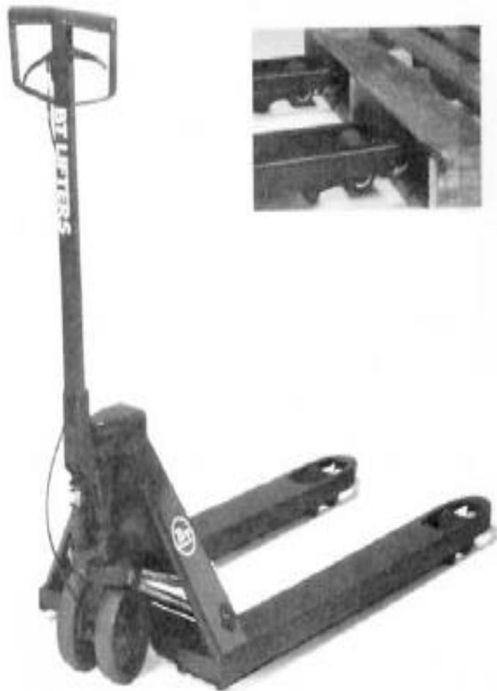
*Figura 3.* Transportador de pallets. Fuente: Meyers & Stephens, 2006.
