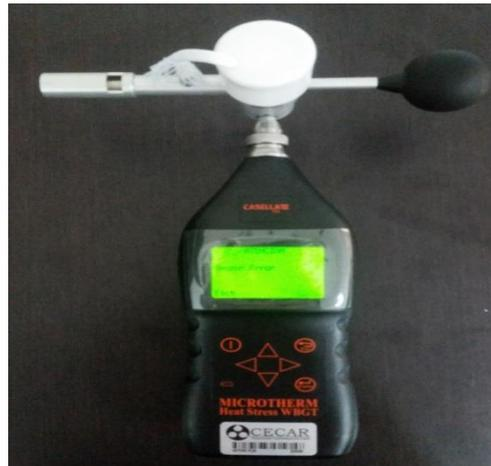
*Figuras 4.* Equipo Microterm Heat Stress WBGT. Fuente: propia 2017
