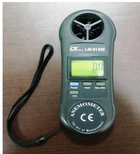
*Figuras 5.* Equipo Anemómetro Digital. Fuente: propia 2017
