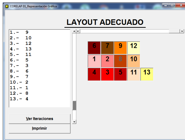
Figura 29. validación por CORELAP, distribución óptima de la planta de la empresa Fuente: Elaboración Propia empleando el software CORELAP (2019).
