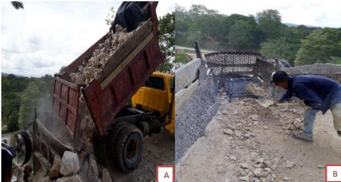
Figura 12: Descargue y alimentador vibratorio del proceso productivo.
