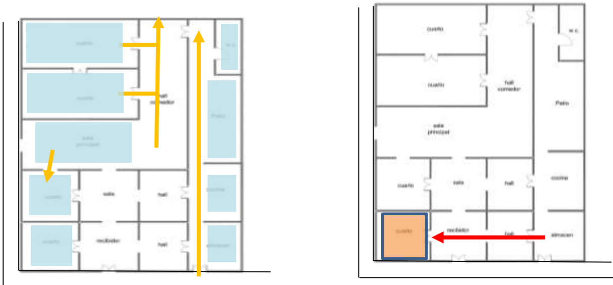
Imagen 83. Relación recorrida entre espacios y recorrida a un espacio de la tipología espacial 3
