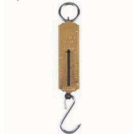
Figura 4. Dinamómetro usado para medir la deformación en el Papel obtenido
