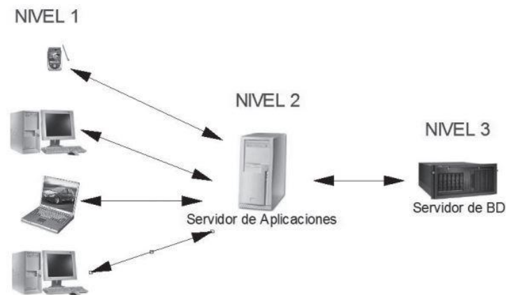
Figura 21. Arquitectura de tres niveles Fuente: (Ferrer, 2012).
